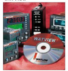
Watview est un logiciel d'Interface Homme Machine permettant de configurer les régulateurs de température et de procédés Watlow sous environnement Windows® 95, 98, NT. Elle peut gérer jusqu'à 32 appareils simmultanément en enregistrant les paramètres de régulation et en traçant des graphiques. Watview communique avec les appareils mono et multiboucles Watlow.
