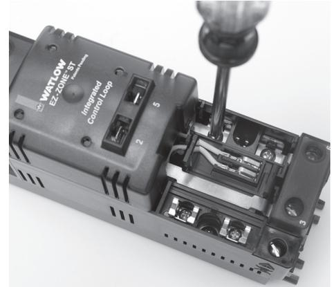
2. Avec un tournevis Phillips, retirez les quatre vis les plus proches sous le module.
