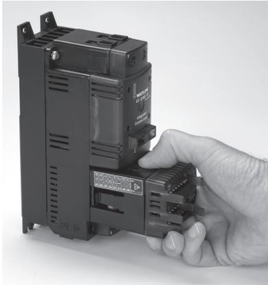
1. Pincez le levier de dégagement en haut et en bas du module de régulation et soulevez le rebord droit vers l'avant pour détacher l'ensemble.
