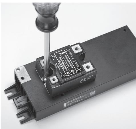
4. A l'aide d'un tournevis Phillips, refixez les deux vis qui connectent le relais statique au dissipateur thermique.
