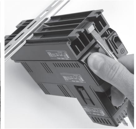
Pour monter le régulateur sur un rail DIN, commencez par fixer le rebord supérieur de l'arrière du dissipateur au sommet du rail DIN. Faites ensuite tourner le régulateur bien droit jusqu'à ce que le rebord inférieur clique en place.
