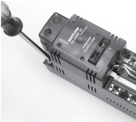
3. Avec un tournevis Phillips, retirez les deux vis des coins supérieurs du régulateur.
