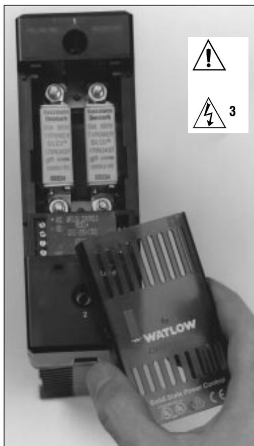
Après avoir mis l'appareil hors tension, utilisez un tourne-écrou de 7/16 pouces pour retirer les écrous de montage de fusibles. Serrage à 4,52 Nm (40 in-lb).
